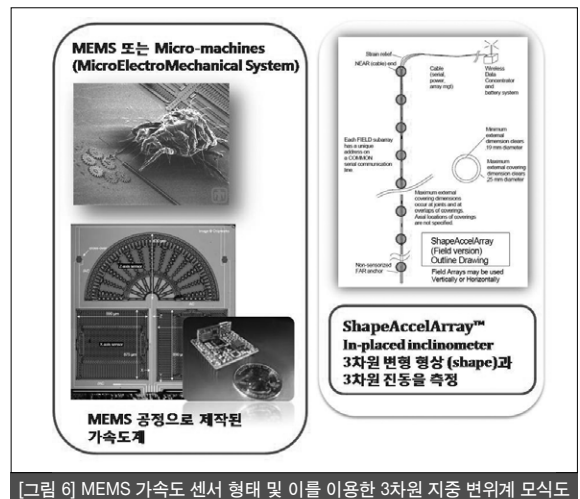
[그림 6] MEMS 가속도 센서 형태 및 이를 이용한 3차원 지중 변위계 모식도
